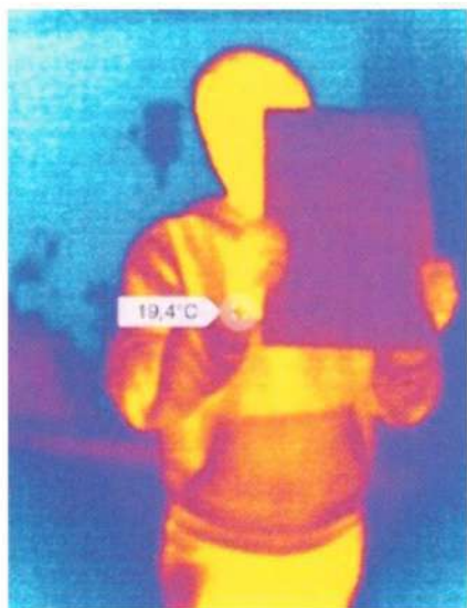
ილუსტრაცია 53: ადამიანს უჭირავს ორმაგი მზისგან დამცავი მინის ფირფიტის ნიმუში. მინის ფირფიტა არ ატარებს ადამიანის გრძელტალღოვან თბურ გამოსხივებას. (ფოტო: თ. დუცია)
