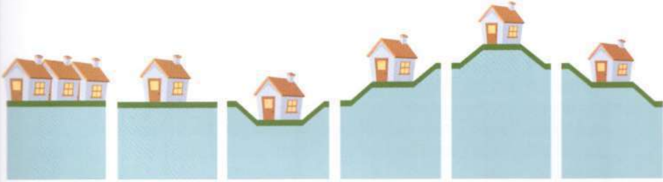
ილუსტრაცია 4: ადგილობრივ კლიმატურ პირობებზე დამოკიდებული თბური ენერგიის მოხმარება. (გრაფიკა: მ. ტყეშელაშვილი, წყარო: მ. გრაუტჰოფი, ვ. შოლი, დებულება: ინტეგრირებული დაპროექტების ინსტრუმენტები მზის ენერგიის გამოსაყენებლად ურბანულ პირობებში Building a new century-5th)
